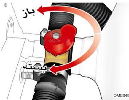
خودرو را به فضای باز انتقال دهید. سپس بعد از باز کردن بست لوله های خرطومی، این لوله ها را از روی محل اتصالات کنار کشیده و در صورتی که هریک از لوله ها بر اثر هرگونه ضربه تغییر شکل داده اند، نسبت به تعویض آن لوله اقدام نمایید. با کف (اسپری نشت یابی و یا کف صابون) نسبت به نشت یابی اتصالات فشار قوی اقدام کنید. در صورت وجود نشتی در اتصالات و یا تعویض لوله ها، پیچ های محل اتصالات را تا اندازه تعیین شده محکم نمایید و در صورت نیاز نسبت به تعویض مهره ماسوره یا ممگی لوله ها اقدام فرمایید.
