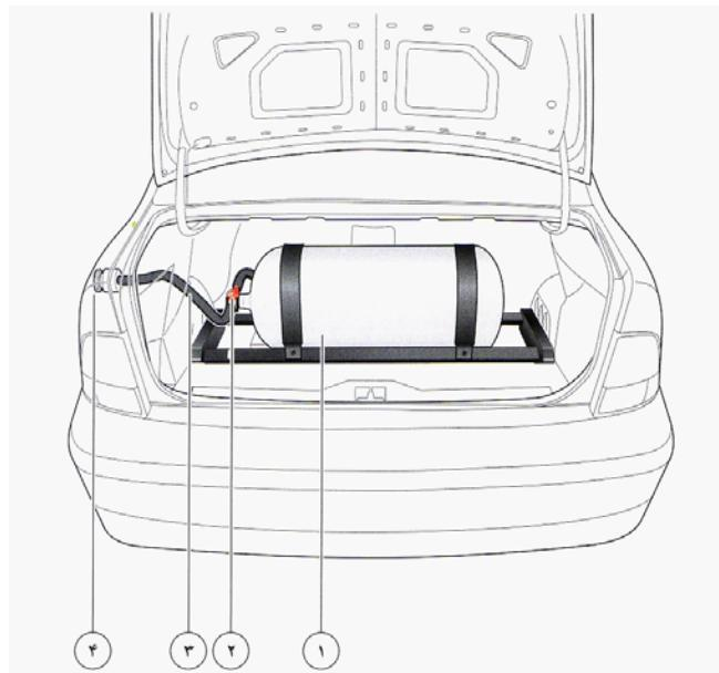
گاز طبیعی توسط لوله فشار قوی(که از جنس فولاد با روکش لاستیکی است) به رگولاتور فرستاده می شود. گاز پس از گذر از رگولاتور و کاهش فشار، به فیلتر و پس از آن به ریل سوخت(انژکتورها) رسیده و از آنجا به نازلها فرستاده می شود (به منیفولد این خودرو چهار نازل برای تزریق گاز اضافه شده است). کلیه ارتباطات ذکر شده توسط شیلنگهای مخصوص می باشد.
