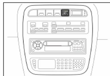
**کلید تبدیل نوع سوخت**
