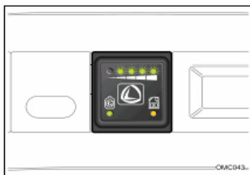
کلید در حالت تبدیل بقزین به کاز بعد از فشار دادن کلید تبدیل سوخت در حالت بقزین علاوه بر روشن بودن چراغ سمت راست (نارنجی) چراغ سمت چپ (سبز) نیز روشن می شود و چراغ های بالای کلید تبدیل در حالت چشمک زدن قرار می گیرد.
