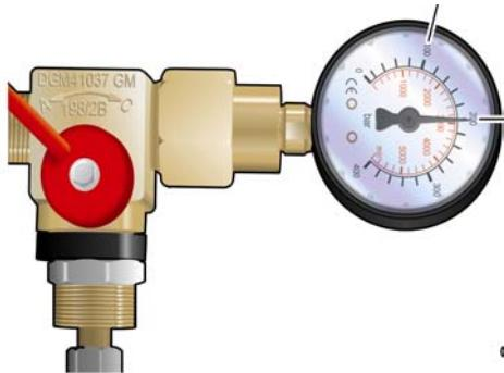
نشت گاز از لوله فشار قوی انتقال دهنده گاز از مخزن به محفظه موتور: در دهانه خروجی شیر سر مخزن سیستمی مکانیکی قرار داده شده(Excess Valve) که در صورت خروج گاز با فشاری بیش از فشار ورودی رگولاتور(شکستگی لوله) فشار خروجی را تا حد زیادی محدود می کند. با این حال در صورتی که در مسیر لوله فشار قوی ترکیدگی یا تغییر شکلی مشاهده شود، حتماً باید لوله مذکور به طور کامل تعویض گردد.
